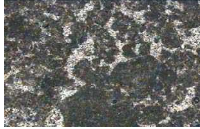
Şekil 7. Peloidli, kireç çamurtaşı dokusunda kireçtaşı. Örnek boşluklu olup, boşluklar tamamen kalsitle doldurulmuştur. Kayada gözeneklilik bulunmamaktadır (Büyütme: 10x).
